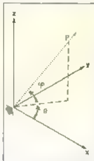
Fig. 2 - La direction d'une droite partant d'une origine est définie par deux angles d'azimut et de site.
